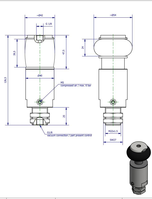
Hauptwerkstoff: Abmessungen: Ø40 x 126,5 mm Gewicht: 0,253 kg Kurzbezeichnung: IGB 41 42-54 ASS Maschinenbau GmbH Klef 2 D-51491 Overath Artikel-Nr.: +49 2206/90547-0 www.ass-automation.com 1-474-00-08 Automations-Systeme Änderungsdatum: 03.09.2020 ASS behält sich Änderungen im Zuge der technischen Weiterentwicklung vor.
